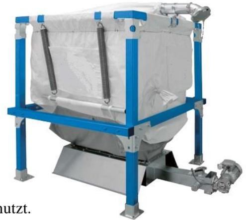
Bei dieser Silo-Konstruktion wird das komplette Gestell als Lagerraum genutzt. Durch Federkraft wird eine vollständige Entleerung des Silos ermöglicht. Die bewährte Trogschneckenentnahme garantiert eine sichere und dosierte Saugförderung der Holzpellets. Alle Silos sind aus antistatischem Polyestergewebe u. seitliche Befüllung mit Prallschutz.
