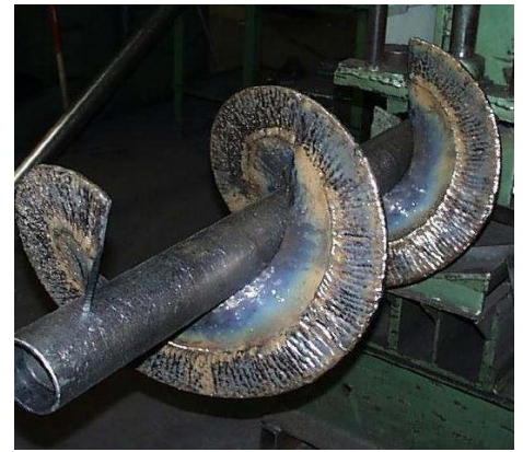
Schneckenflügel mit Aufpanzerung
