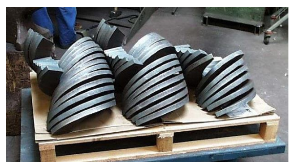
Schneckenflügel in unterschiedlicher Materialstärke
