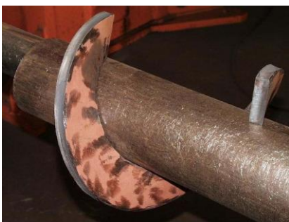
Schneckenflügel mit Material 12mm
