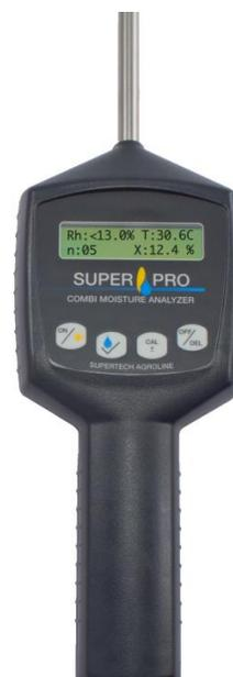
Heufeuchtemesser, Strohfeuchtmesser, Messgerät für Feuchte im Stroh
