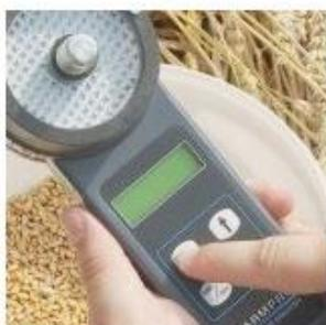
Drücken der ON/TEST-Taste einschalten. Die sorte durch Betätigung der Pfeiltasten wählen.
