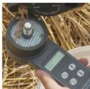
Die Probe in das Mahlwerk geben. Die Probenmenge wird im eingebauten Messbecher gemessen.
