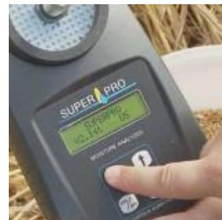
Der Superpro Getreidefeuchtemesser: in vier einfachen Schritten leicht zu bedienen:
