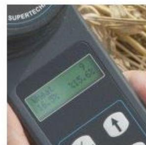
Die ON/TEST-Taste drücken, und den Feuchtigkeitsgehalt direkt vom Display ablesen.
